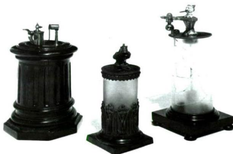
Figura 1. Döbereiner's Lighter. Museo de Ciencia de Inglaterra.
